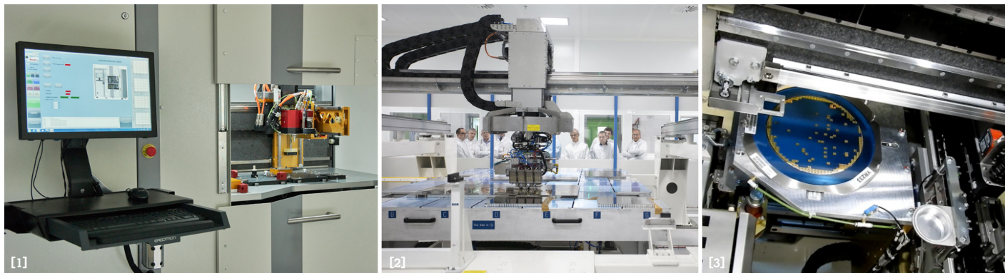
[1] Une machine spéciale de frittage laser. [2] Assemblage de panneaux photovoltaïques pour le spatial. [3] Alimentation de puces en wafer.
